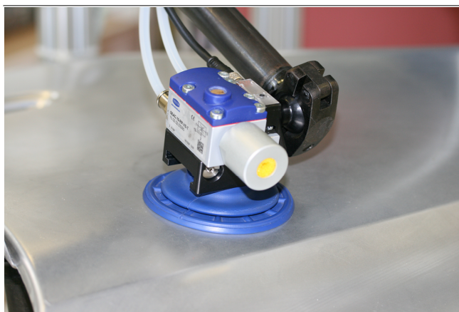
Generación de vacío descentralizada mediante eyectores SEAC RP con sistema de expulsión directamente en la ventosa
